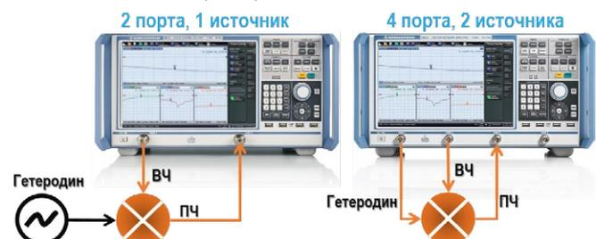
Одной из основных причин, снижающих рабочие характеристики ИУ, являются интермодуляционные составляющие, возникающие при подаче на вход ИУ нескольких сигналов. Оценить нелинейные свойства ИУ поможет опция интермодуляционных измерений (ZNB-K14).
