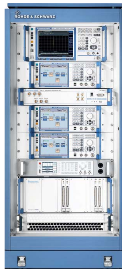
Пример конфигурации: трехканальная система для моноимпульсного радара.
