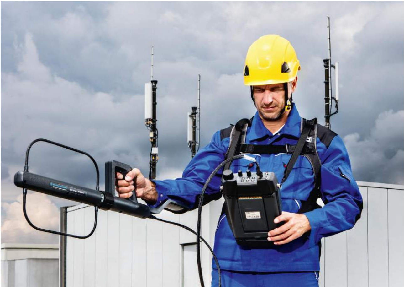
Поиск помех при помощи антенны R&S HE400 с модулем R&S HE400HF
