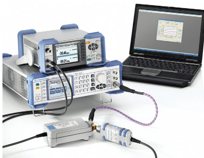
Измерительная установка для калибровки преобразователя мощности NRP-Z55
